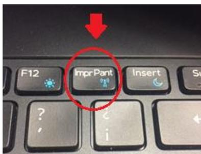
Figura 21. Ejemplo de interruptor físico Bluetooth.
