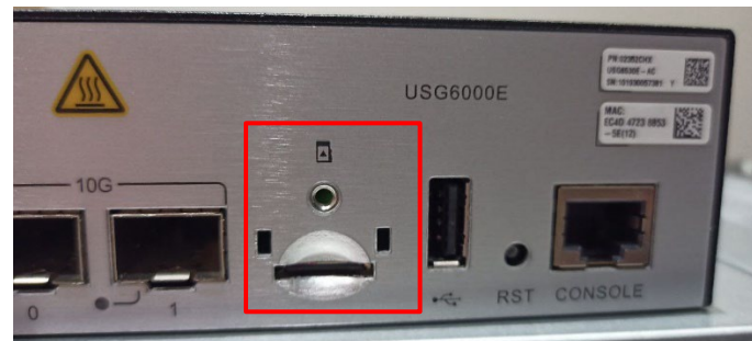
Ilustración 3: Parte trasera del firewall, donde se debe insertar la tarjeta SD.
