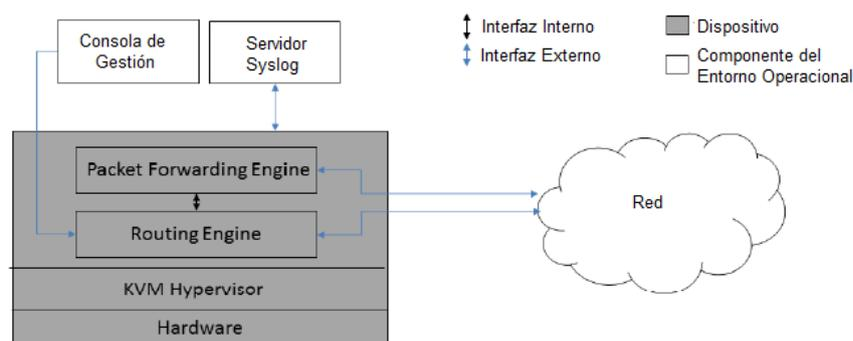
Figura 1- Arquitectura Física del dispositivo EX4300-48MP
