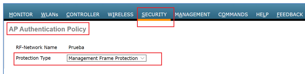
Ilustración 52. Protección de MFP a nivel de infraestructura
