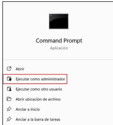
Ilustración 81 - Ejecución como administrador de CMD
