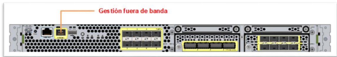
Conexión de la gestión fuera de banda Firepower 4100
