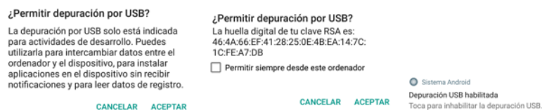
Figura 53 - Activación de las capacidades de depuración por USB
