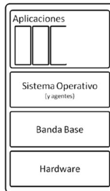
**Figura 4. Estructura de capas “lógicas” propia de un dispositivo móvil.**
