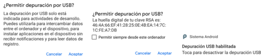
Figura 59 - Activación de las capacidades de depuración por USB
