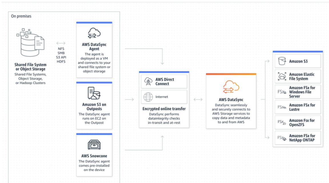
Fig.30 - Transferencia de datos con AWS DataSync
