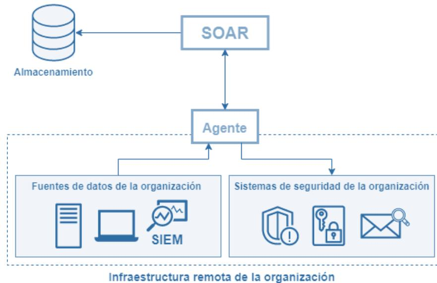
Figura 2 –. Ejemplo de Caso de Uso 2: Gestión de alertas de seguridad mediante agentes.
